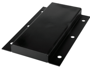
SOPORTE DE EXTENSIÓN Utilizado cuando la saliente del tope debe aumentarse y esto no puede lograrse eligiendo un tamaño de tope con la saliente adecuada. También pueden usarse para prolongar un tope existente hasta la saliente adecuada. Los soportes de extensión pueden enviarse con los topes soldados para una instalación más sencilla en un único paso.*
