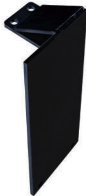
COMPONENTE ELEVADOR ESTÁNDAR CON RECORTE Utilizado en aplicaciones en las que la abertura de la puerta es estrecha o en donde es aceptable una mínima intrusión a la abertura de la puerta para evitar la interferencia con la carga y la descarga.
