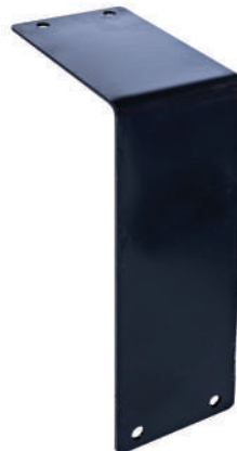
PLACA DE MONTAJE Utilizada cuando el concreto en el lugar de montaje del tope está dañado e impide la instalación segura del tope de carga del andén. La placa de montaje del tope puede hacerse más ancha y alta para permitir sujetarla a concreto más sólido. Pueden enviarse con los topes soldados para una instalación más sencilla en un único paso.
