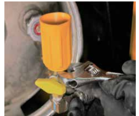
INSTALE EL ACOPLE EN LA VÁLVULA DE PROPANO CON UNA LLAVE
